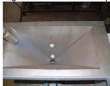
Abb. 4: Der Saatguttrichter ist mit Niveauschaltern für „Leer“ und „Voll“ versehen.
