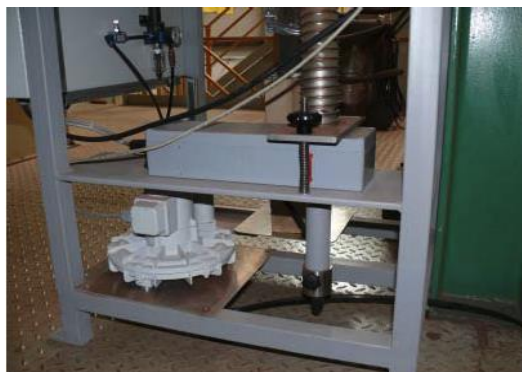
Abb. 2: Das Radialgebläse saugt die mit Staub beladene Luft durch das Photometer
