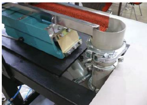
Abb. 5: Die Geschwindigkeit der Vibrationsrinne wird automatisch geregelt.
