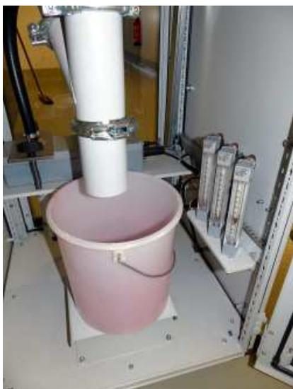
Abb. 3: Das vermessene Saatgut landet im Auffangbehälter.
