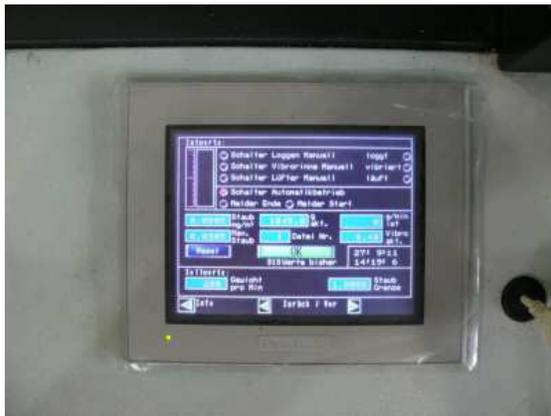
Abb. 7: Über das Touch-Screen-Display lassen sich alle erforderlichen Parameter direkt eingeben.
