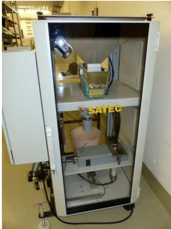
**Staubmessgerät „Dust Monitor“ zur Bestimmung der
