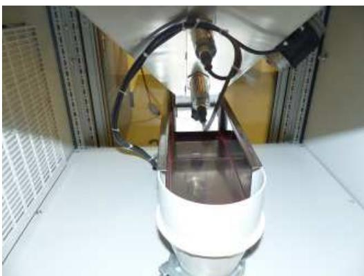
Vibrationsrinne: Regelbare (entweder von Hand oder per Automatik) Saatgutrinne oberhalb des Messrohres mit angeflanschem Saatguttrichter aus Edelstahl. Schiebehülse zur Einstellung der Saatgutschichtdicke in der Rinne. Typ: AVITEQ Typ KF1-2, max. 6000 Schwingungen pro Minute.
