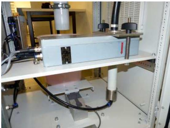
Abb. 2: Die Straubpartikel werden mittels Vakuum durch das Photometer gesaugt.
